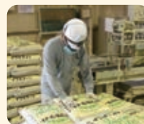
採掘されたゼオライトは、 全て石見鉱業所に集められ、1週間ほど自然乾燥 した後に工場へ加熱し、強制 乾燥します。そして、用途 に応じて破碎し、袋詰め。「イ ワミライト」「MGイワミライ ト」の商品名で全国に出荷 しています。
